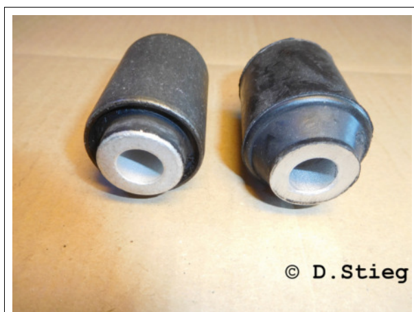
Bild 2-7.1: Gummi-Metalllager der Federlenker in verschiedenen Versionen. Links mit Blechmantel (■■■■■). Rechts ohne Blechmantel (■■■■■ ■■■■).
