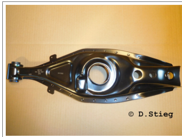
Bild 2-6: Federlenker mit Gummi-Metalllager zur Befestigung am Achsrahmen (links). Ansicht von unten. Beidseitig identische Federlenker.
