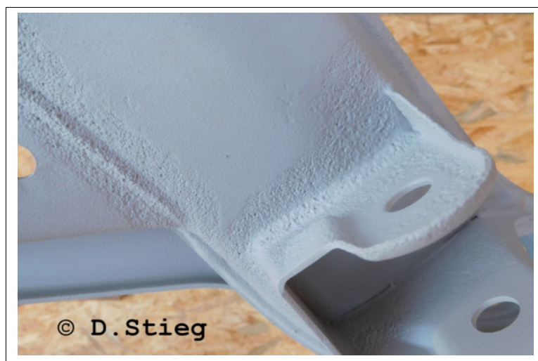
Bild 2-2: „Rostnarben“ als typische Korrosionsspuren an einem sandgestrahlten und lackierten Achsrahmen.
